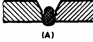
Şek. 318A — Uygun bir selülozik elektrodla çekilmiş kök pasosu. Cüruf kenarlarından kolaylıkla temizlenir.
