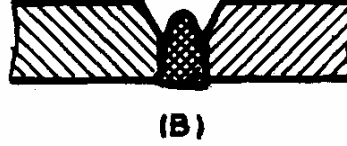
Şek. 318B — Uygun olmayan bir selülozik elektrodla çekilmiş kök pasosu. Cüruf kenarlarından güç temizlenir.
