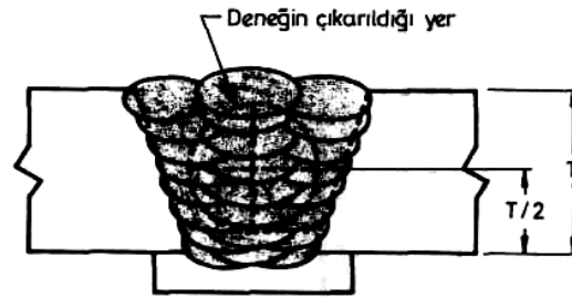
Şekil: 24 — Tam kaynak metali çekme deney numunesinin boyutları ve alınacağı yer.
