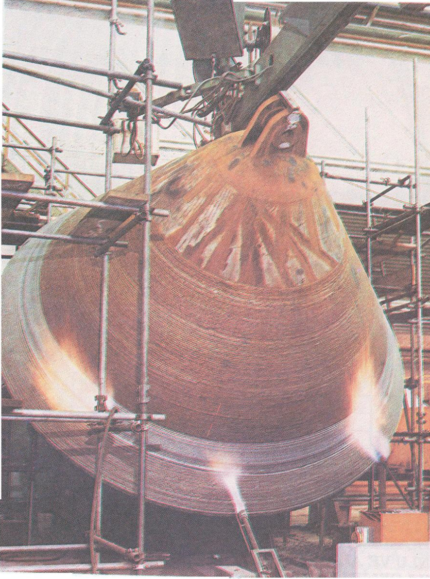
Şek 63.- Yüksek fırın kampanalarının da aksenel olarak simetrik parçalardan olmalarıyla bunların da dolgusu bir döner kaynak tablası üzerinde yapılır
