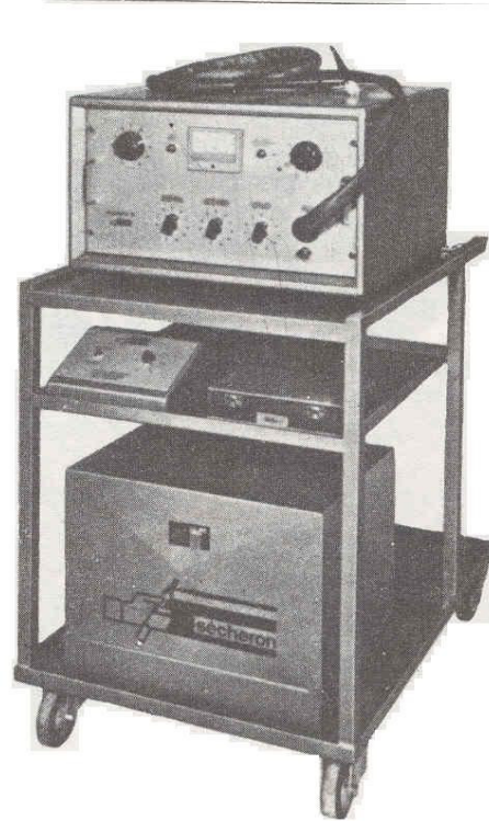
Şek.29-Bir Mikro-Plasma tesisi ya bir masa üzerinde ya da soğutma sistemiyle gaz tüplerini taşıyan bir araba üzerinde duran bir metalik kasa şeklini arzeder.
