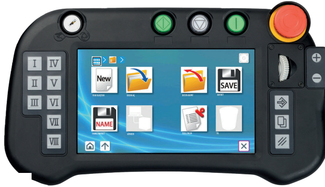
İş eldiveni ile de kullanılabilen dokunmatik ekran
