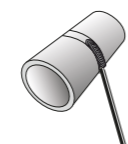
Boru Yatay Eksende Sabit Yukarıdan Aşağı Pozisyon PJ / 5G
