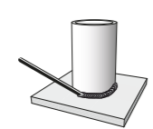
Boru Dikey Eksende Sabit Yatay Köşe Pozisyon PB / 2F
