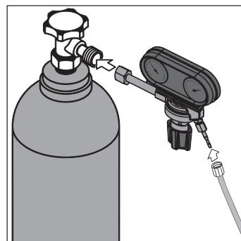
Şekil 3 : Gaz Tüpü Bağlantısı
